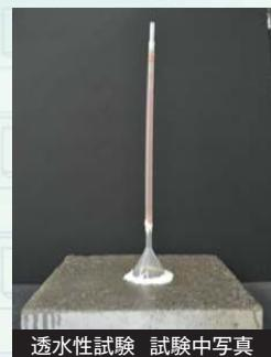
※試験方法及び判定基準 JIS A 6021 建築用塗膜防水材 ウレタンゴム系 参考 透水性試験 JIS A 6909 建築用仕上塗材 参考
