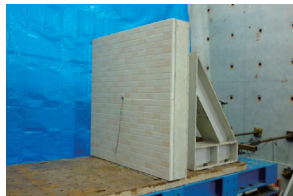
試験体 No.1 下地モルタル層あり エバーガードSG-1工法 施工無し
