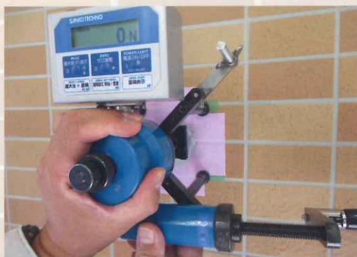
④ 引張試験器テクノスターRJ-1にて目地モルタル強度確認試験を行う
