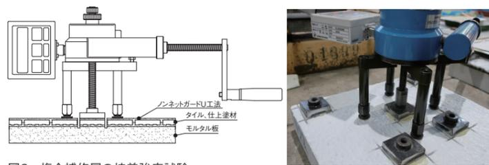
図3 複合補修層の接着強度試験
