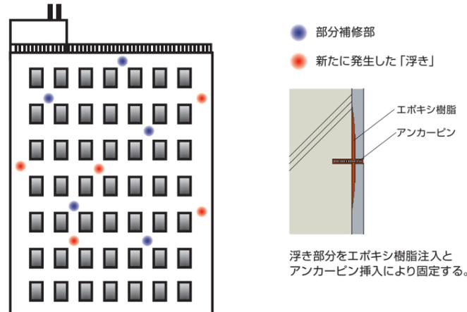
一般的な補修方法で、タイルやモルタルの“浮き”が発生している部位に対し、アンカーピンとエポキシ樹脂を用いてタイルやモルタル等の仕上げ層と躯体（くたい）コンクリートを再度接着させる。
