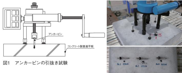
図1 アンカーピンの引抜き試験
